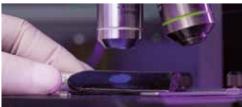
DIKTE - Fluorescentie microscoop bij 20X vergroting. Standard UNI EN 1849-1.
