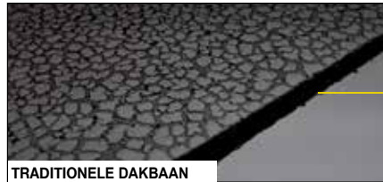
3,000 uur in QUV blootstelling veroudering.
