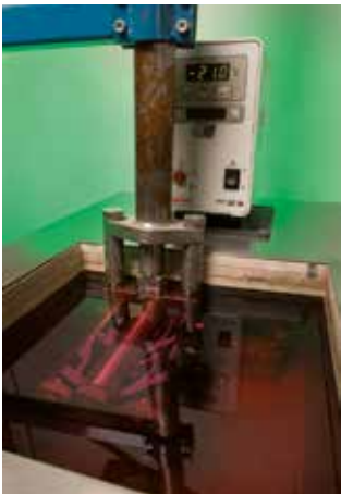
KOUDE BUIG FLEXIBILITEIT - Thermo-cryostaat (met buigmachine). Standard UNI EN 1109.
