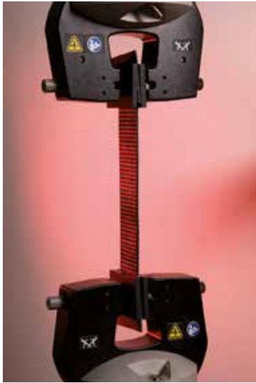
TREKSTERKTE - Dubbele kolommen dynamometer met 5kN loadcel. Standard UNI EN 12311-1.
