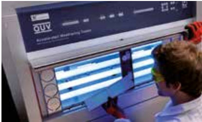
UV VEROUDERING - QUV straling in UV verouderingskabinet. Standard UNI EN 1297 (3,000 uur blootstelling cycli).
