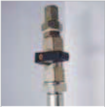
Ventiel aan het eind van de slang: gesloten
